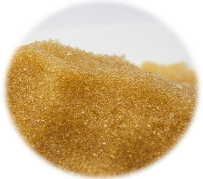
La vida útil de las resinas de intercambio iónico generalmente se sitúa entre 5 y 10 años. Para las resinas catiónicas, la vida útil teórica varía considerablemente, estimándose entre 200 y 1500 m<sup>3</sup> de agua tratada por litro de resina, dependiendo directamente de la calidad del agua de entrada.
